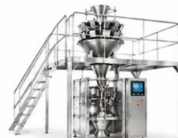
Весовое дозирование и автоматическая упаковка
