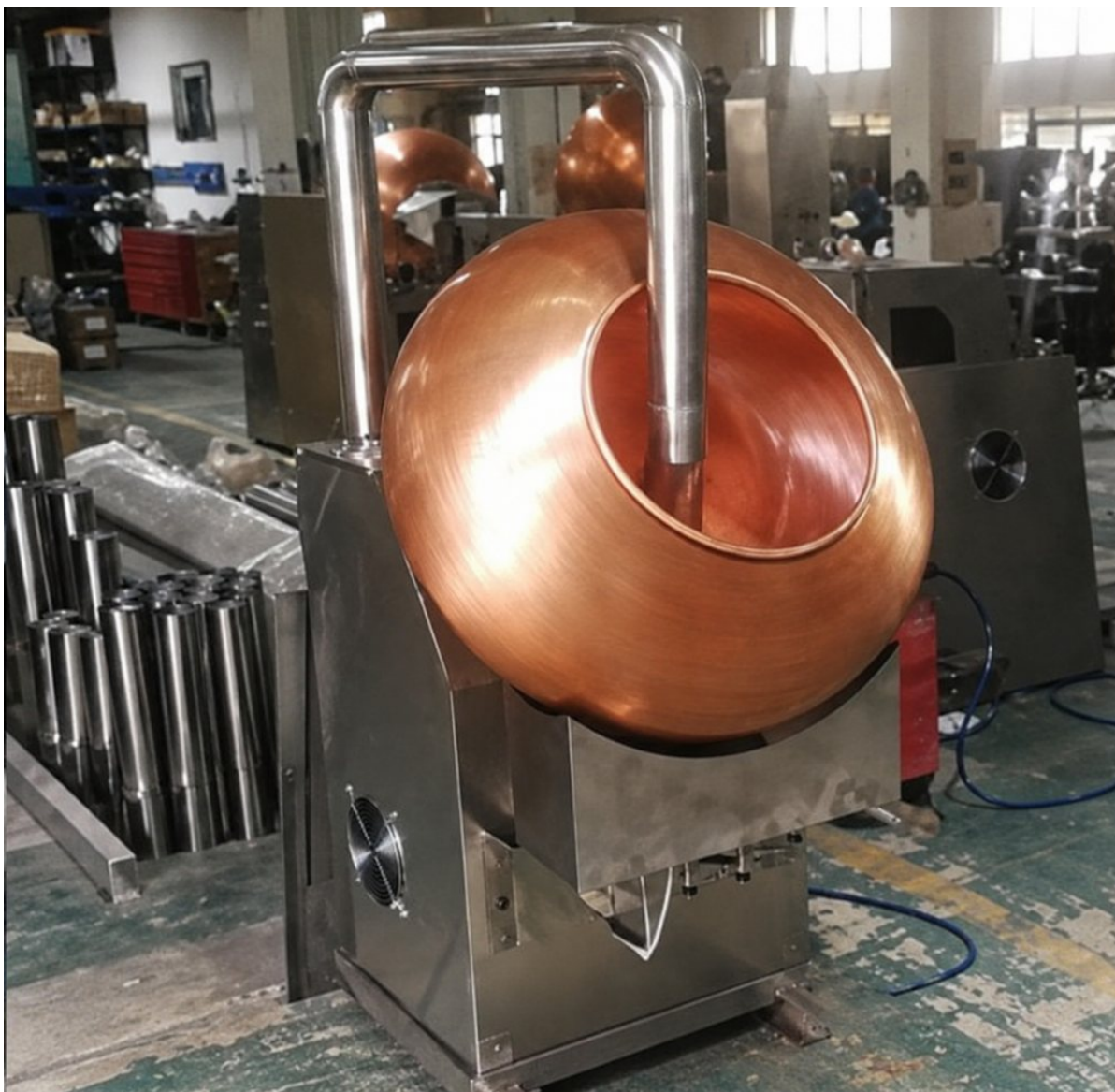
Дражировочная машина с медным барабаном и газовым нагревом
