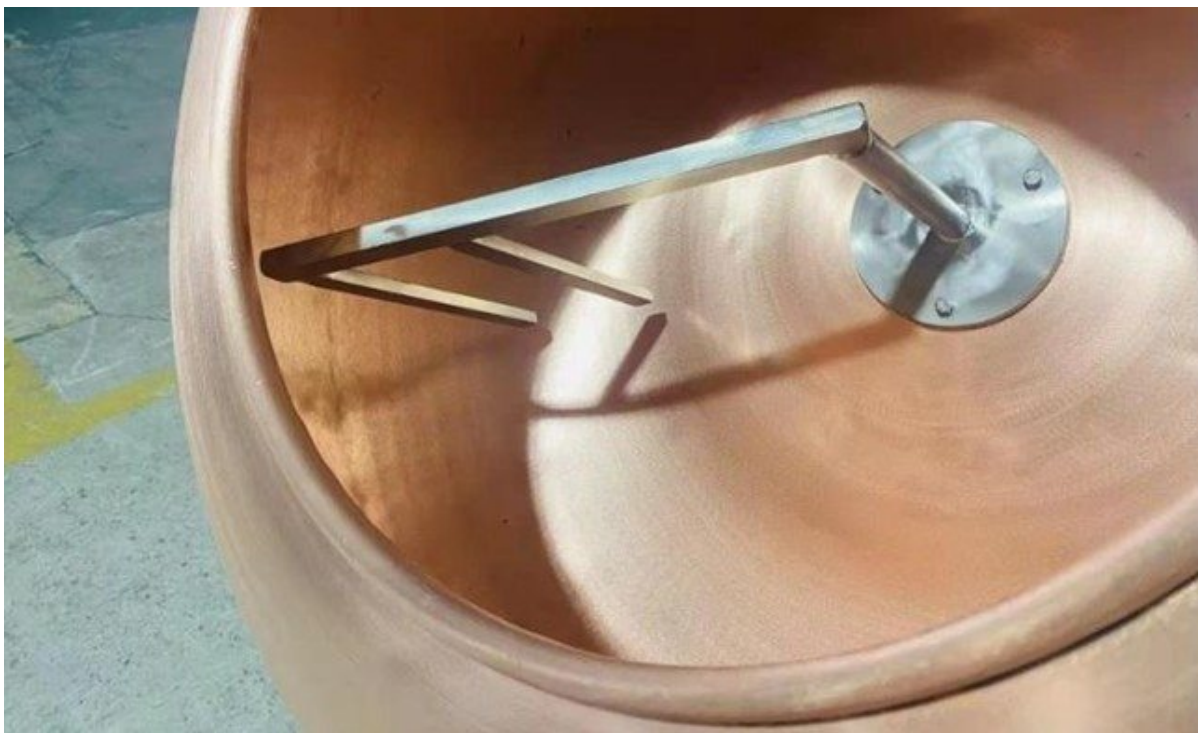
Медный котел и внутренняя мешалка дражировочной машины BYQ.
