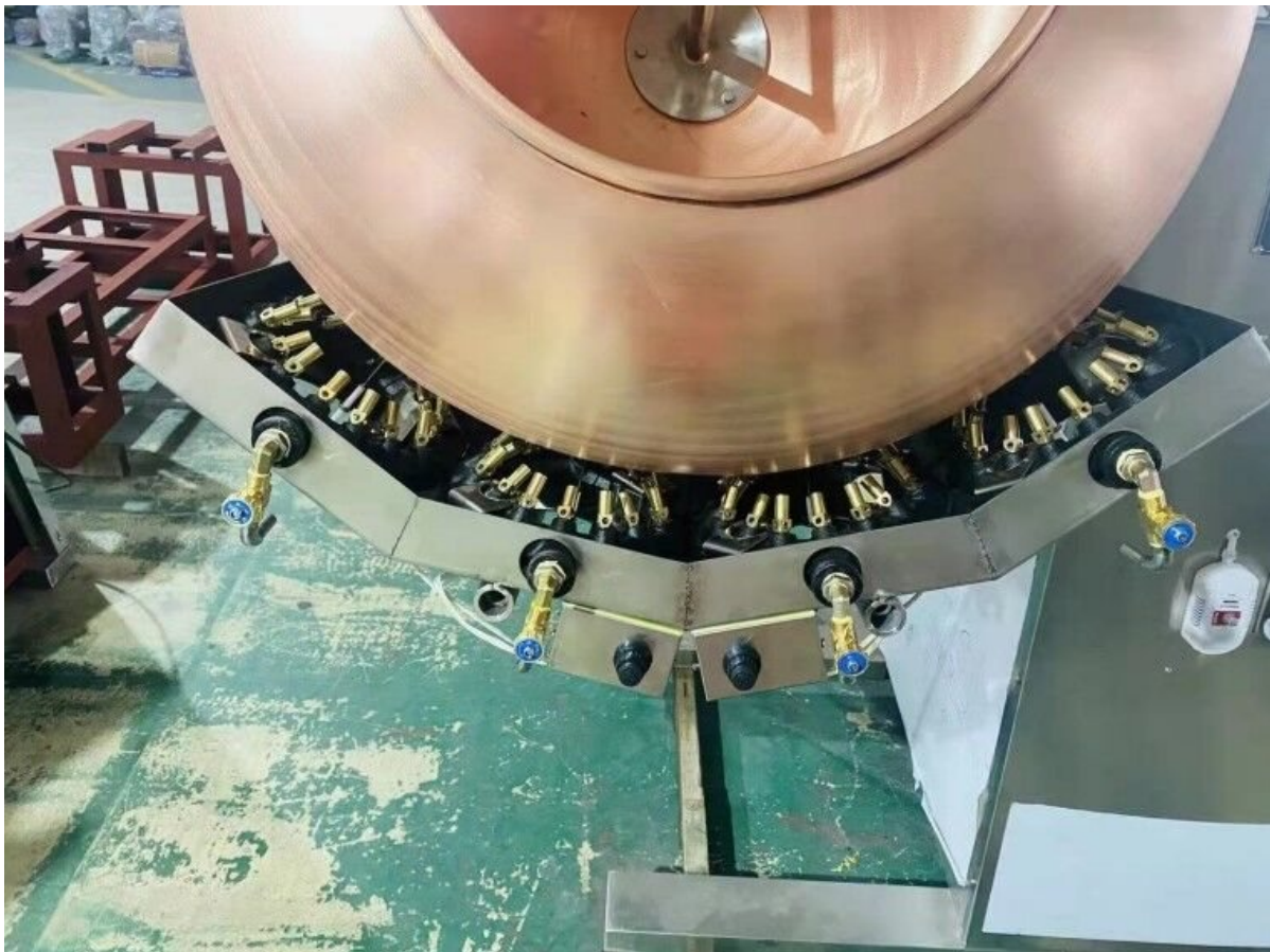
Нижняя часть медного дражировочного котла и элементы системы нагрева
